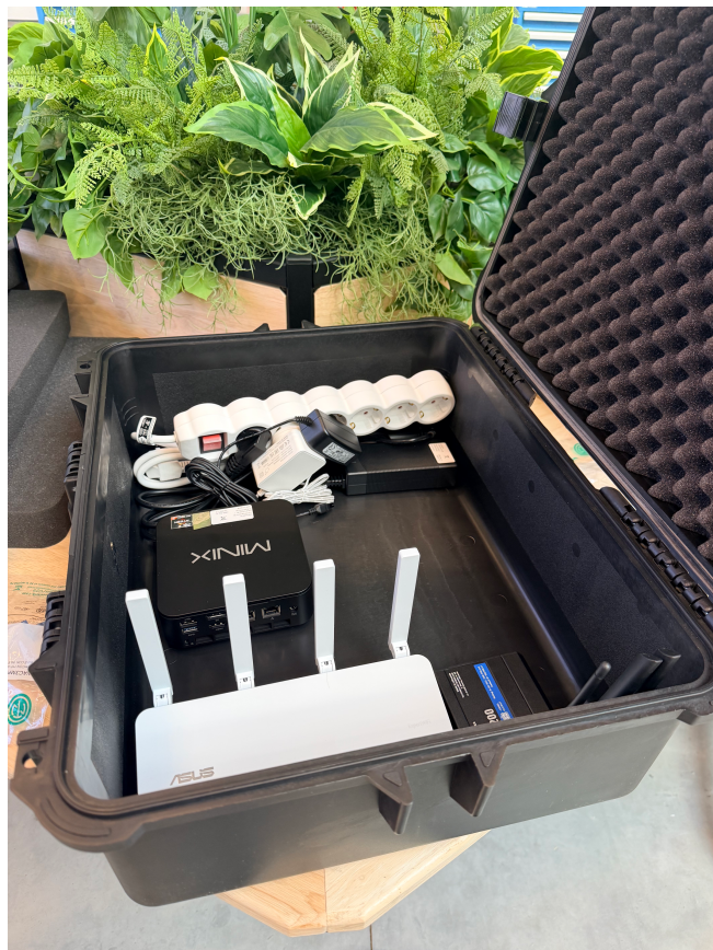
PoC-koffer met netwerkapparatuur voor veilige productie-integratie (voorbeeld koffer)
